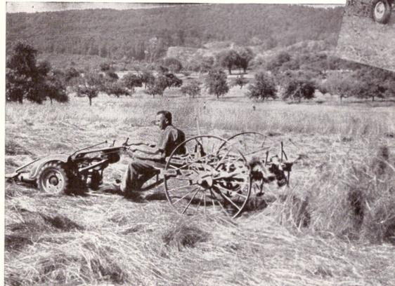
Die ANHÄNGEDEICHSEL mit Kutschersitz in Verbindung mit dem zum jeweiligen Anhängegerät passenden ANSCHLUSSSTÜCK ermöglicht das Anhängen verschiedener Heubearbeitungs-Maschinen an den Handmotormäher HM und HML. Die Deichsel ist für alle Anhängegeräte gleich. Auf einfache Art ist die Verbindung zwischen Zugvorrichtung der Maschine und dem Anhängegerät herzustellen.
