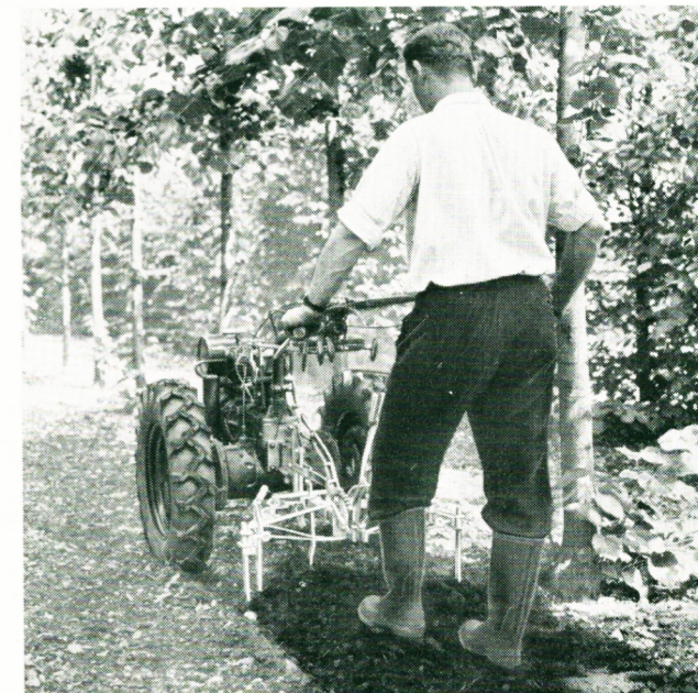
Unten: FR mit Kultivator mit Schnellverstellung
