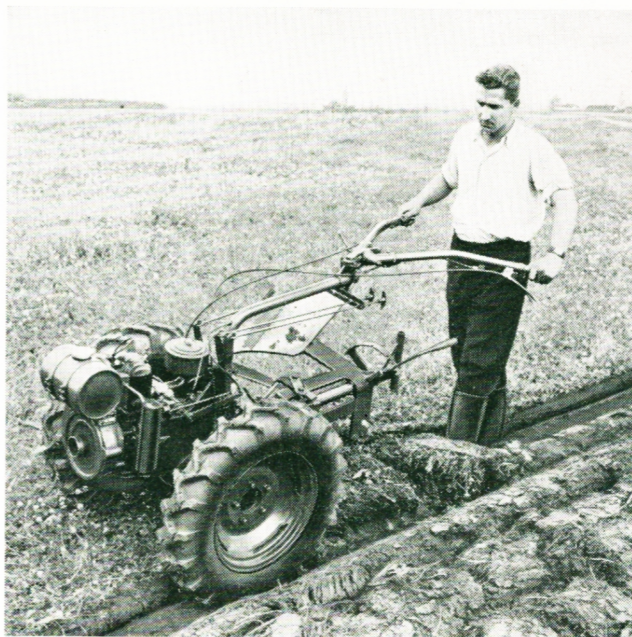
Unten: FR mit Drehpflug beim Wiesenumbruch
