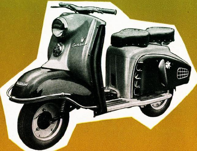
Weitere Besonderheiten: Elektrischer Anlasser, Gebläsekühlung, direkte Leerlaufschaltung aus jedem der 4 Gänge, Triebsatzschwinge. Geschwindigkeit 90 km/std. Seitenwagenfest.
