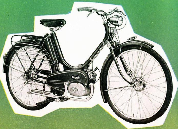
Eine groß dimensionierte Vorderrad- und eine kräftige Rücktrittbremse garantieren höchste Fahrsicherheit. Steuer-, führerschein- und zulassungsfrei.
