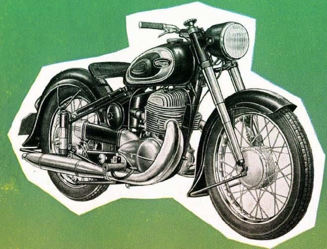
Vierganggetriebe, Fußschaltung, Allradfederung, Leichtmetall-Vollnabenbremsen, Hinterradbremse hydraulisch mit Anschlußmöglichkeit für die Seitenwagenbremse.
