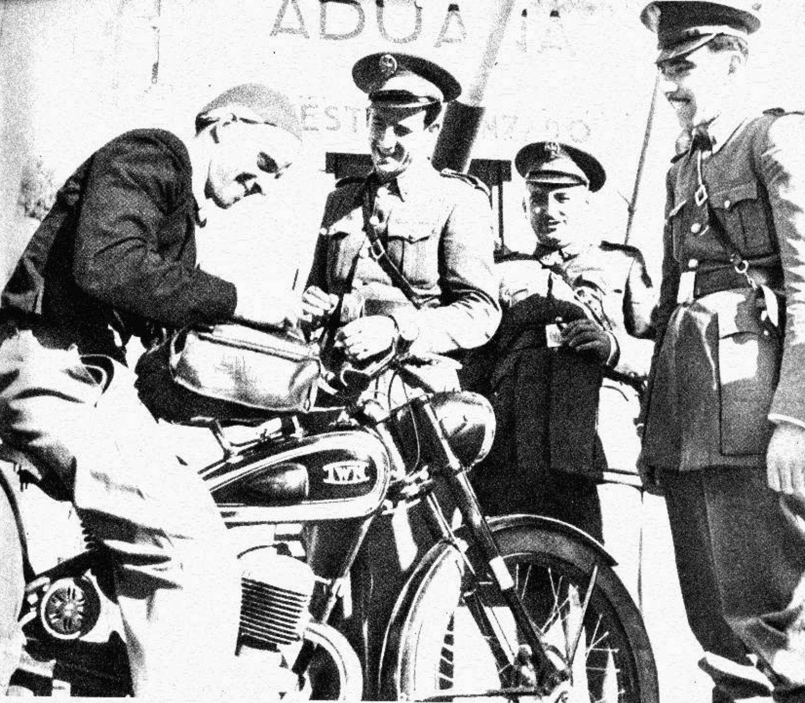
TWN — das ist die Auslandsbezeichnung für Triumph, „Triumph-Werke Nürnberg“, zum Unterschied von English-Triumph. Hier sieht man auch schön, worin der Witz des Tank-Gepäckträgers besteht: Die dicke Tasche bleibt frei von den Oberschenkeln des Fahrers. Foto: Simons
