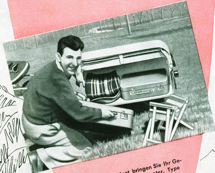
Sauber und geordnet bringen Sie Ihr Gepäck im Campo-Anhänger unter. Type „Filius“, besonders für Motorräder geeignet, hat ein Gewicht von 18 kg, eine Tragfähigkeit von 100 kg, ist 90 cm lang, 45 cm breit und 45 cm hoch. Die Eigenart der Konstruktion erlaubt ein minutenschnelles Zusammenlegen des Anhängers, so daß er auf kleinstem Raum aufbewahrt werden kann.
