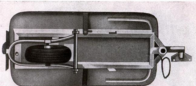
Ruhiger und spurfester Lauf bei jeder Geschwindigkeit durch progressive Abfederung und Spezial-Luftbereifung
