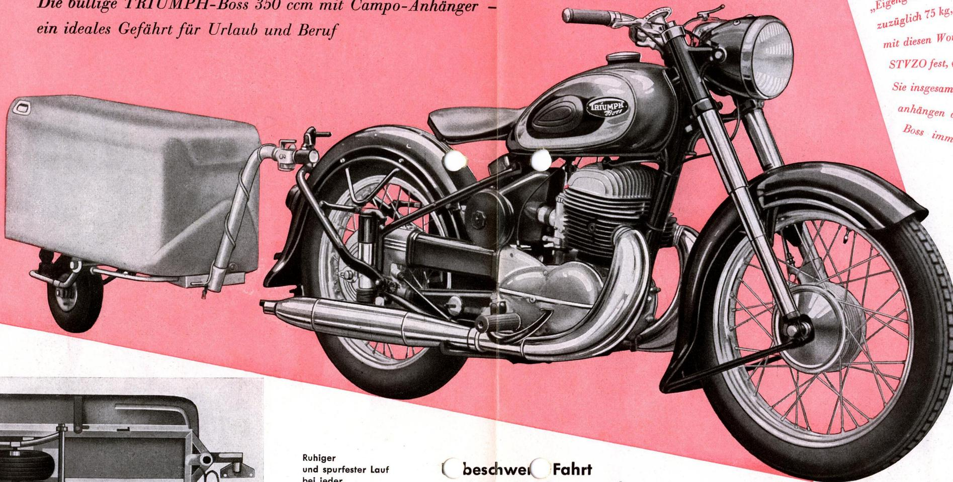
„Eigengewicht des Motorfahrzeuges zuzüglich 75 kg, dividiert durch 2“ - mit diesen Worten legt die STVZO fest, wieviel kg Gewicht Sie insgesamt an Ihr Fahrzeug anhängen dürfen, also bei der Boss immerhin 126 kg!
