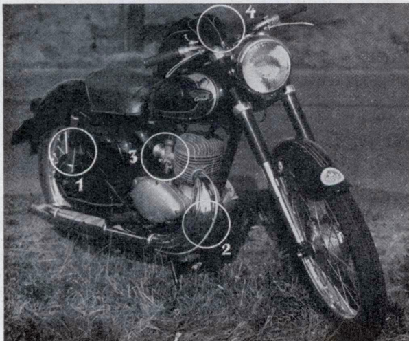
1) Hintere Schwinge mit Federbeinen. 2) Große Auspuffbirne zur Schalldämpfung. 3) Ansaugeräuschkammer und 4) schmaler Lenker sind die Punkte, die zuerst auffallen
