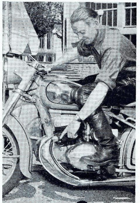
Wie die hier im Bild gezeigte Viktoria KR 26 werden vermutlich eines schönen, nicht mehr allzufernen Tages auch andere Motorräder sehr zur Freude aller Verkehrsteilnehmer Auspuffbirnen oder andere schalldämpfende Bauteile aufweisen.
