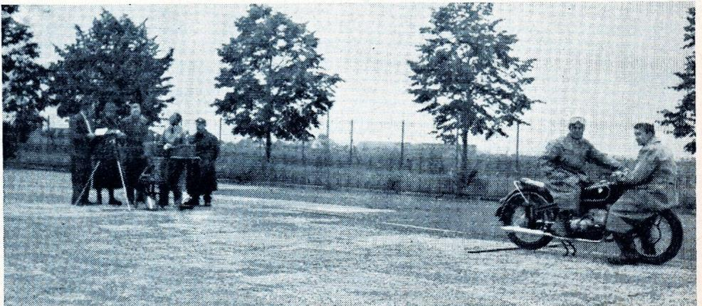
So wie hier gezeigt, geht die Schallmessung vor sich. Genau sieben Meter hinter der Maschine stehen die Meßgeräte. Ein Mann setzt sich auf das Vorderrad der Maschine, damit das Hinterrad frei wird, und dann wird aufgedreht, bis der Tacho die Höchstgeschwindigkeit zeigt, also hier bei der R 68 160 km/h.
