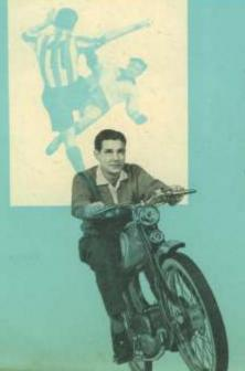
er es dem Fahrer, sich so in Positur zu setzen, wie es ihm gerade Freude macht. Weitere Feinheiten: verkleideter 47-ccm-2-Gang-Sachsmätor, Vorderrad- und Triobsatzschwinge, geschlossener Kettenkasten, 23×2,25"-Reiten (auf Wunsch Weißwandreifen), Gepäckträger, Werkzeugkasten, dauerabgeblendeter 15-Watt-Scheinwerfer, Schwarz mit Schweinfurtgrün kombinierte Lackierung.
