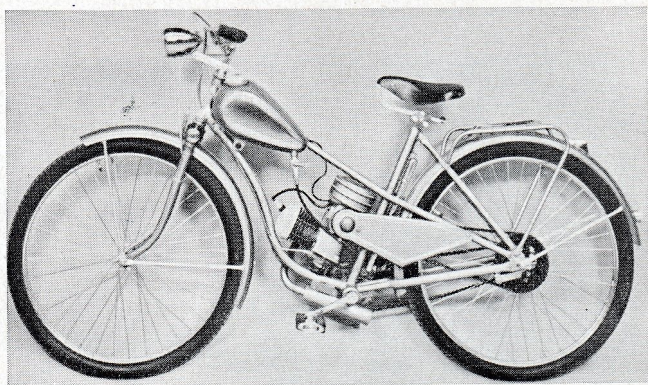
Lutz: Exportmodell mit Doppelrohr-Rahmen, Federgabel und drei Bremsen. Lutz-Motor 48 ccm 1,6 PS mit abnehmbarem Aluminium-Zylinderkopf, großem Luftfilter und Membran-Steuerung. Motorbremse durch Stahlkonus-Kupplung. Schwungradmagnetzähler mit Lichtspule. Kettenantrieb auf das Hinterrad. Höchstgeschwindigkeit 40 km/h.
