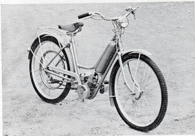
Rex: Spezialfahrrad mit dem bekannten Rex-Motor, der vor dem Tretlager eingebaut ist. Kupplung mit Sperrklinke und Raster. Keilriemenantrieb. Über den Ilo-Einbaumotor Typ F.P. 50, der speziell für das Moped entwickelt wurde, berichteten wir ausführlich in MOTOR-RUNDSCHAU mit NKZ Heft 4/1953 auf Seite 138.
