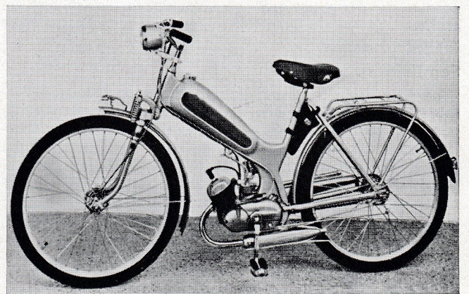
Expreß : Spezial-Tankrahmen, Federgabel, Trommelbremsnaben, Block-Zweitaktmotor 1,5 PS, Hinterradantrieb mit nur einer Kette, Spitzengeschwindigkeit 40 km/h, Steigvermögen 15%.
