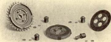
Triumph-Kupplung: Kupplungs-Zahnkranz, Lamellen,
