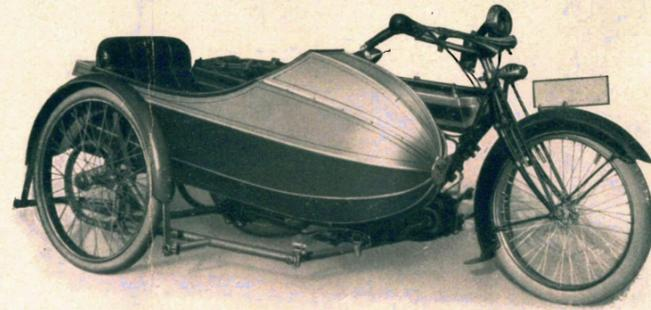
Karosserie aus leichtem, jedoch äußerst stabilem Holzeisen-Gerippe, mit wasserdichtem, imprägniertem Segel bezogen; obere Haube aus Aluminiumblech; Lackierung in der jeweiligen Farbe des entsprechenden Motorrades; Untergestell mit Laufrad
