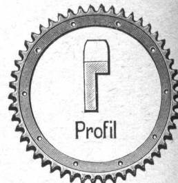
Nr. H 24/5280 Für Ardie \frac{5}{8} \times \frac{3}{8}'' , 49 Zähne, Bohr. 209 mm 10 Befestigungslöcher . . . RM 66.—
