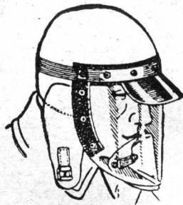
Ideal-Gesichtsschützer mit Atemscheibe, verhindert das Beschlagen der großen Scheibe. Schwammgummi-Einfassung
