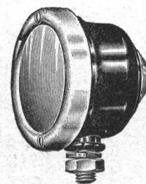
Nr. M 805/1880 Beiwagenlampe mit matter Glasscheibe, roter Rücklinse, Gehäuse schwarz, Glasring blank . . . RM 25.—
