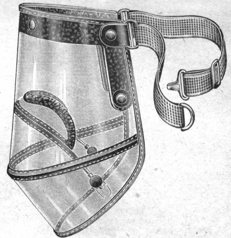
Primus-Gesichtsschützer mit nach unten geschlossenem Halsschutz; neuartiger Nasensteg verhindert Beschlagen. Rostsicher überzogener Stahldraht-Formhalter. Körperband-Einfassung, Seiten- und Stirnteile mit Filzpolsterung
