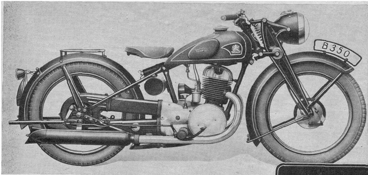
Die Triumph „B 350“ ist eine Kettenmaschine mit klarer Linienführung und völlig gekapselten Antriebssteilen.
