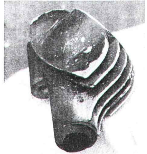
Der Ansaugdämpfer war früher mal Ölbehälter, tut's aber prima, wenn er auch wirklich rundum dicht geschweißt ist.
