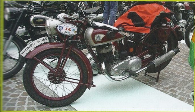
Triumph S-350, Starrahmen und Parallelogramm-Vorderradgabel sind typische Konstruktionsmerkmale von Weltkriegsmaschinen.
